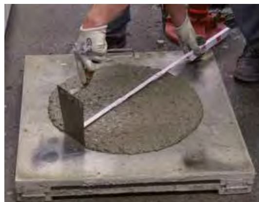
Die Tendenz zu weicheren Konsistenzen beim Einbau des Frischbetons hält weiter an.
