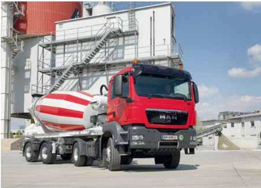
**TGS Fahrmischer.** Fahrmischer mit 2-Achs-Zugmaschine und 2-Achs-Auflieger. Der Vorteil der höheren Nutzlast spricht für sich. Den bisherigen Rückmeldungen zufolge werden diese Fahrzeuge hauptsächlich als Fahrmischer eingesetzt. Die mögliche Zweitnutzung mit einem Kipperanhänger wird bisher offensichtlich weniger ausgenutzt.
