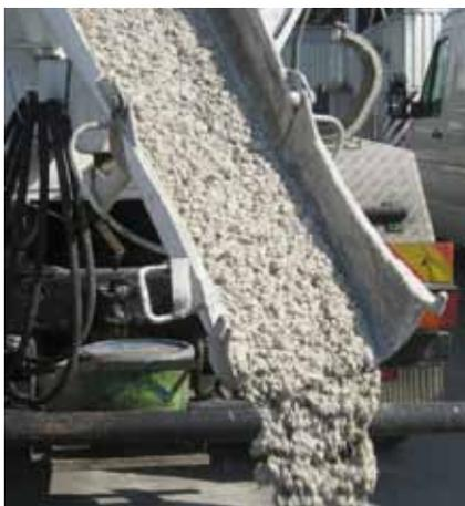
**Fahrmischer mit Betonrutsche** – „Die neue Europä- ische Betonnorm EN 206 wird vermutlich Ende 2013 vorliegen – dann ist auch unsere Betonnorm ÖNORM B 4710-1 anzupassen.“
