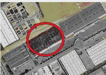
*Bild FB 9.1: Luftbild der ausgebrannten Lagerhalle nördlich von Rognac in der Nähe von Marseille, das erkennen lässt, wie sich der Brand über das gesamte Gebäude ausbreitete, in dem es keine abschottenden Betonwände gab (Quelle: SDIS 13, Fire and Rescue Service, Bouches du Rhone, Frankreich)*
